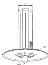
Cápsula plástico 40 con espiga Plastic cap 40 with pivot Embout plastique 40 avec pivot Calotta plastica 40 con perno
